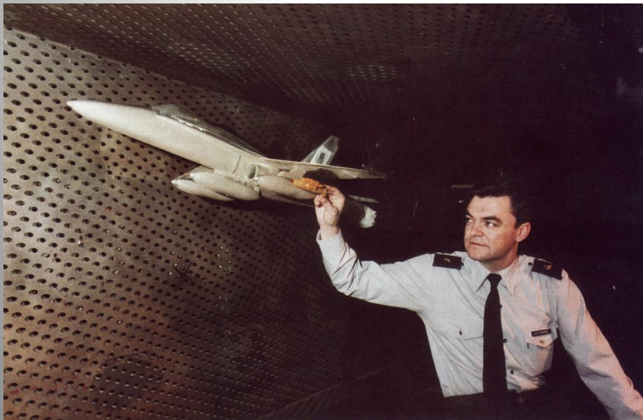
Ensayos en el túnel aerodinámico de ARNOLD (AEDC-USAF) de caída libre (lanzamiento de una maqueta de TER-9A modificado y una bomba BR-500).
