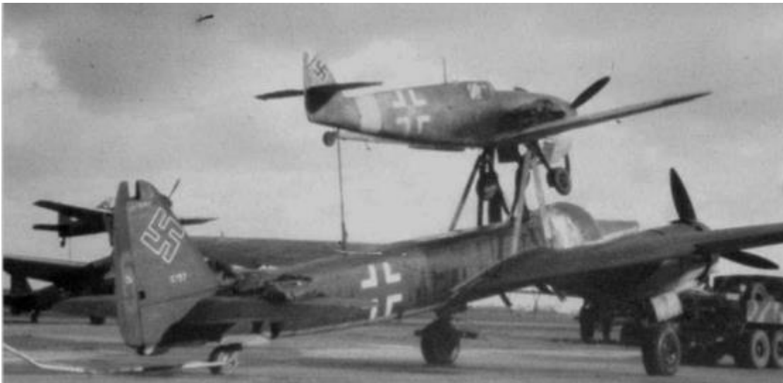
Combinación Mistel de Me-109 G y Ju 88 en su aparcamiento con otros varios "Mistel". Sólo operaron en la última fase de la sg, desde 1.944 hasta el final de la guerra en mayo de 1.945
